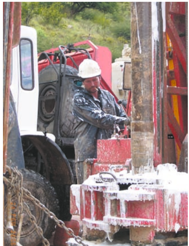
Espumante para perforaciones por roto percusión en terrenos duros.
