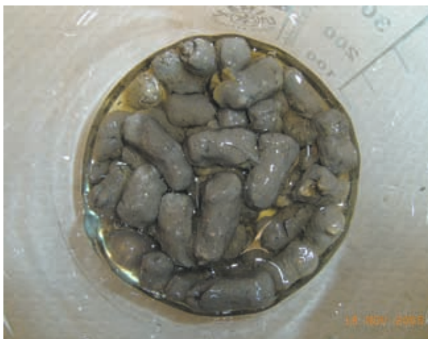
Pellets después de 24 h. en lodo con polímero viscopol
