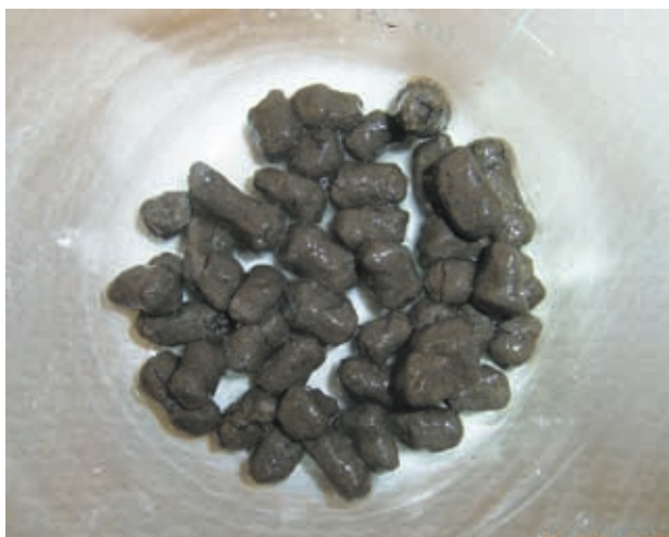
Pellets después de 24 h. en lodo de agua salada con polímero viscopol
