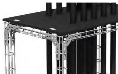
Estructura del sistema con ejes de apoyos
